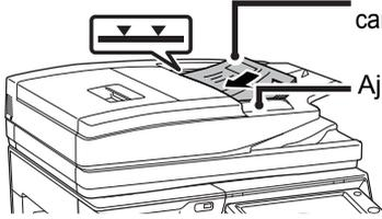
Si el original está doblado, alíselo antes de colocarlo. (Con ello se evita que se atasque el original y que se detecte incorrectamente el tamaño del original)
