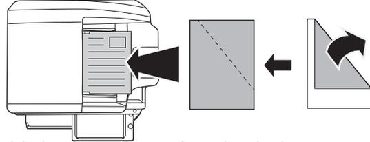
Si el original está grapado, asegúrese de quitar las grapas y airear bien las páginas antes de colocarlas. (Esto sirve para evitar errores de alimentación y desgarres en el original, y para evitar que los fragmentos rotos del original se queden en el alimentador.)
