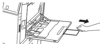
Ajuste las guías de la bandeja bypass de forma que toquen suavemente el papel cargado.
