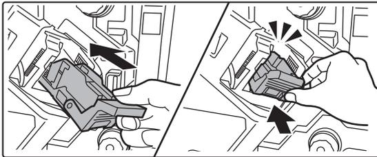
**Empuje firmemente hacia dentro la caja de grapas para volver a colocarla.**
