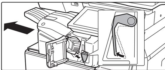
Mientras presiona la palanca hacia la izquierda, deslice el finalizador hacia el mismo lado hasta que se detenga.
