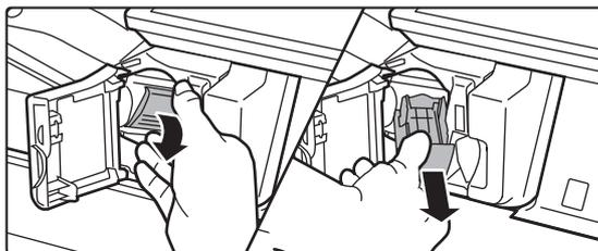
Baje la palanca de liberación de la caja de grapas y retire la caja de grapas.
