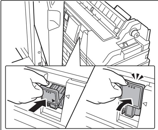
**Empuje firmemente hacia dentro la caja de grapas para volver a colocarla.**
