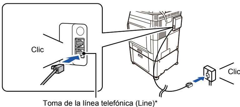
En algunos países, se requiere un adaptador para conectar el cable de línea telefónica a la toma de teléfono de la pared, como se muestra en la ilustración.
