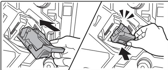
**Empuje firmemente hacia dentro la caja de grapas para volver a colocarla.**
