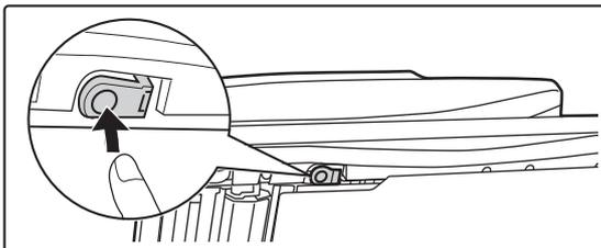
**Abra la cubierta de la zona de escaneado del alimentador de documentos automático.**
