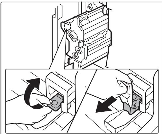
**Baje la palanca de liberación de la caja de grapas y retire la caja.**
