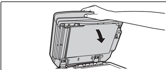
**Asegúrese de que la placa posterior de documentos quede firmemente sujeta al alimentador de documentos automático y después cierre el alimentador de documentos automático.**
