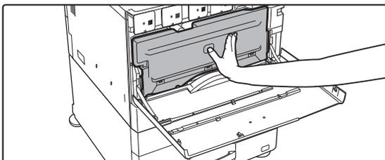
**Empuje la caja de recogida de tóner hacia el interior de la máquina.**
