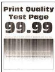
**Nota:** Antes de resolver el problema, imprima las páginas de prueba de la calidad de impresión. En el panel de control, vaya a **Valores > Solución de problemas > Páginas de prueba de la calidad de impresión**. En los modelos de impresora sin pantalla táctil, pulse **OK** para navegar por los distintos ajustes.
