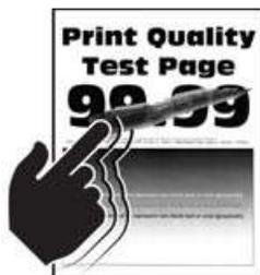
**Nota:** Antes de resolver el problema, imprima las páginas de prueba de la calidad de impresión. En el panel de control, vaya a **Valores > Solución de problemas > Páginas de prueba de la calidad de impresión**. En los modelos de impresora sin pantalla táctil, pulse **OK** para navegar por los distintos ajustes.
